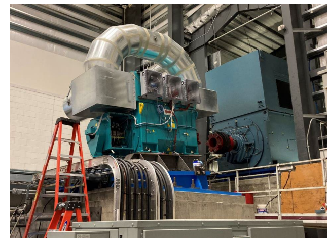
GE 2.3 MW DFIG generator on NREL dynamometer
