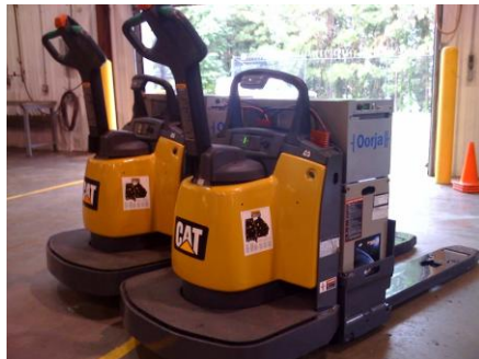
Oorja Protonics' OorjaPac onboard a lift truck
